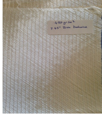
Şekil 6. +/- 45° Biaxial Cam Elyaf, 450 gr/m 2 .
