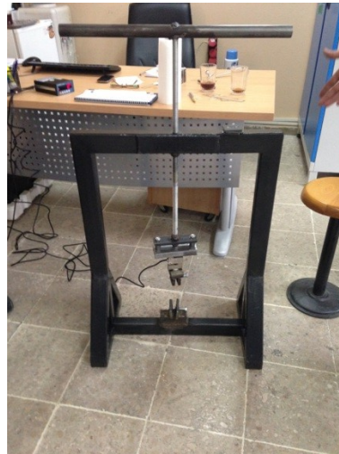
Şekil 19. İmal edilen çekme cihazı.
