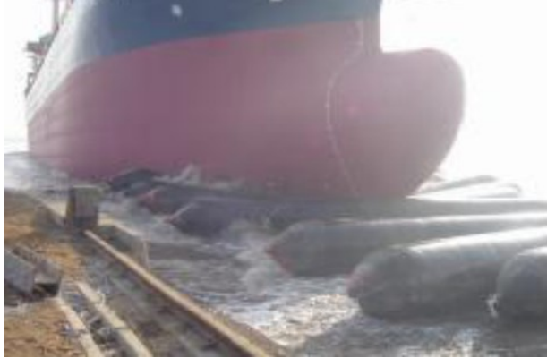
Şekil 9. Geminin balonla denize indirilişi.
