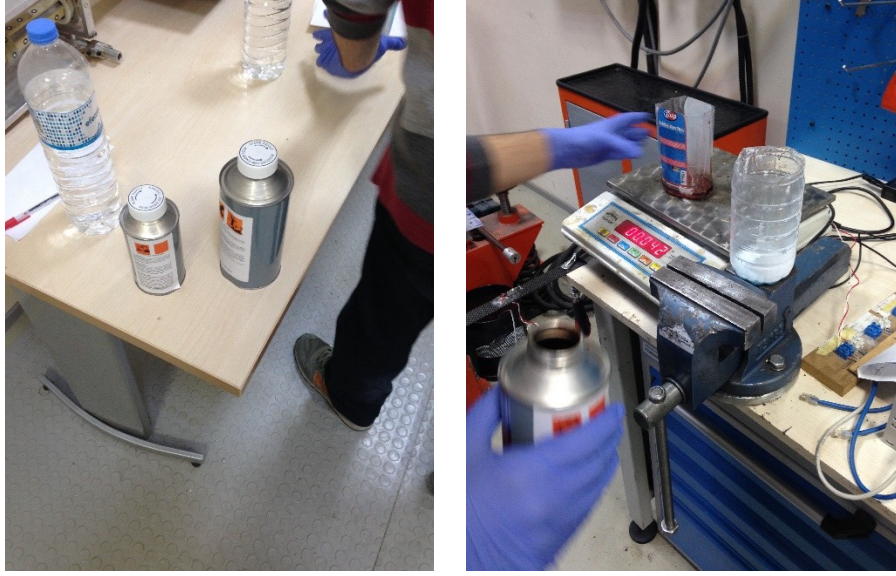
Şekil 11. Numuneler için reçine-sertleştirici oranının ayarlanması.
