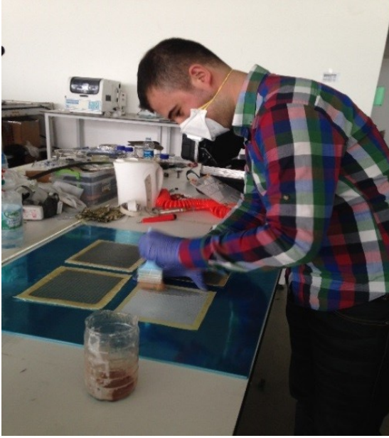
Şekil 13. El-yatırma yönteminin uygulanması.
