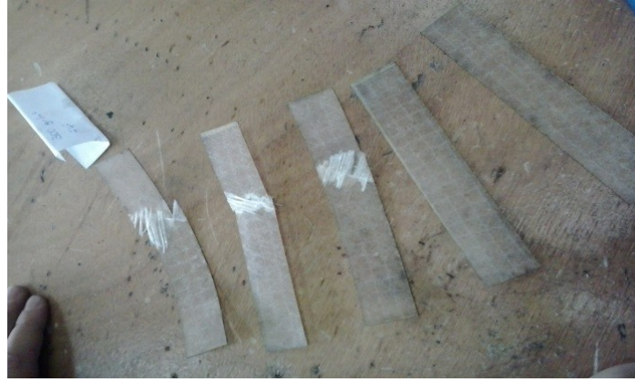
Şekil 22. Numunelerin kopma şekilleri.
