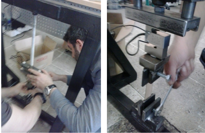
Şekil 20. Numunelerin mengelerce tutturulması.
