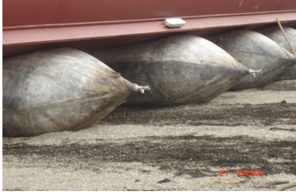
Şekil 8. Gemi balonlar üzerinde otururken
