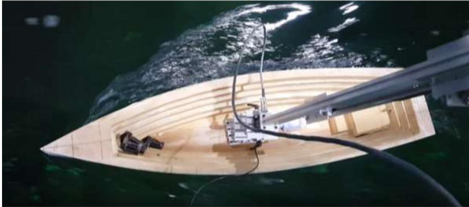
Şekil 3. Salma C, 5° meyil, 5° sürüklenme, karışık dalgalı su, VModel= 1.4 m/s
