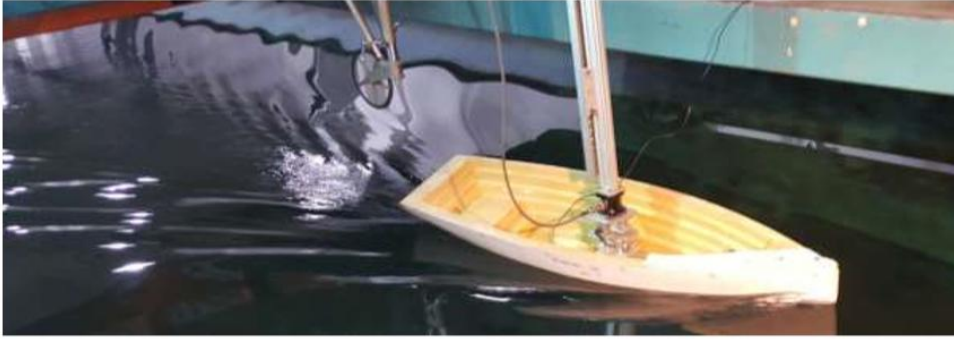
Şekil 2. Salma A, 15° meyil, 5° sürüklenme, durgun su, VModel= 1.6 m/s
