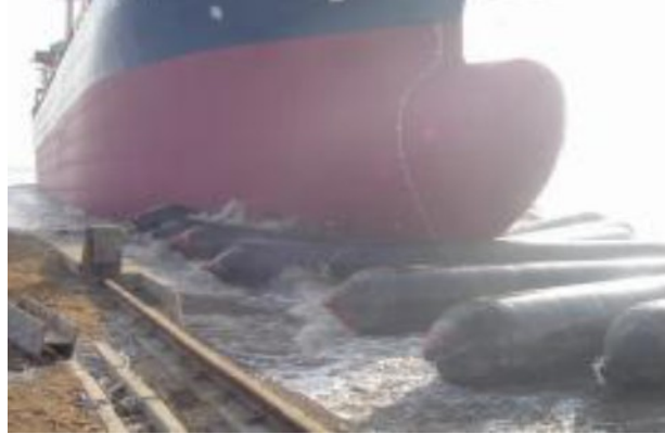
Şekil 9. Geminin balonla denize indirilişi.
