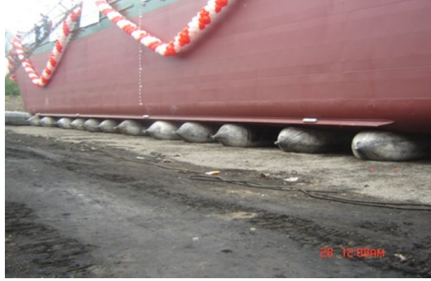
Şekil 6. Balonların gemi altına yerleştirilmesi.
