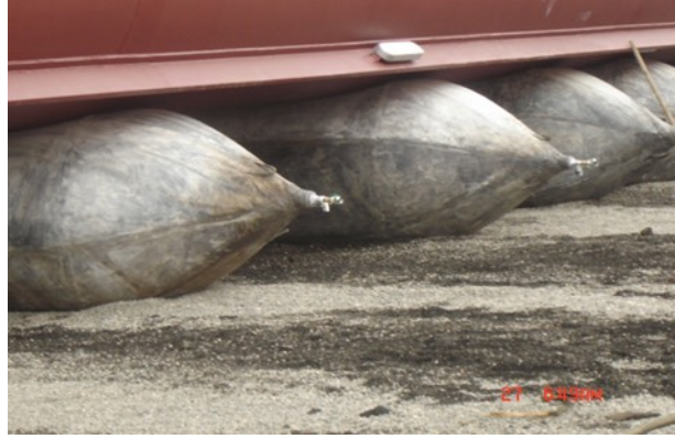
Şekil 8. Gemi balonlar üzerinde otururken
